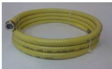
TUBO FLESSIBILE CSST LONG DN12, IN ACCIAIO INOSSIDABILE AISI316L SPESSORE 0,20 mm. RICOPERTO CON GUAINA GIALLA ASSEMBLATO CON 2 DADI DA 1/2" COMPLETI DI GUARNIZIONI. KIT PER ALLACCIAMENTO CUCINE A GAS NORME DI PRODOTTO UNI EN 15266:2007 E NORME DI INSTALLAZIONE UNI 7129:2015
